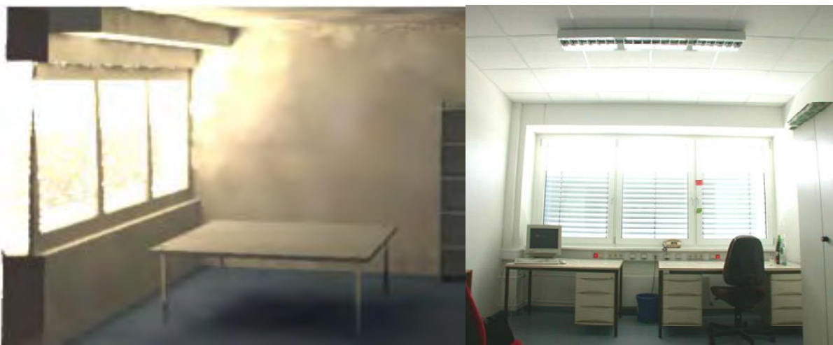
Bild 3–16: Tageslichtlenkung in einem südorientierten Büroraum – Simulation und Realität
