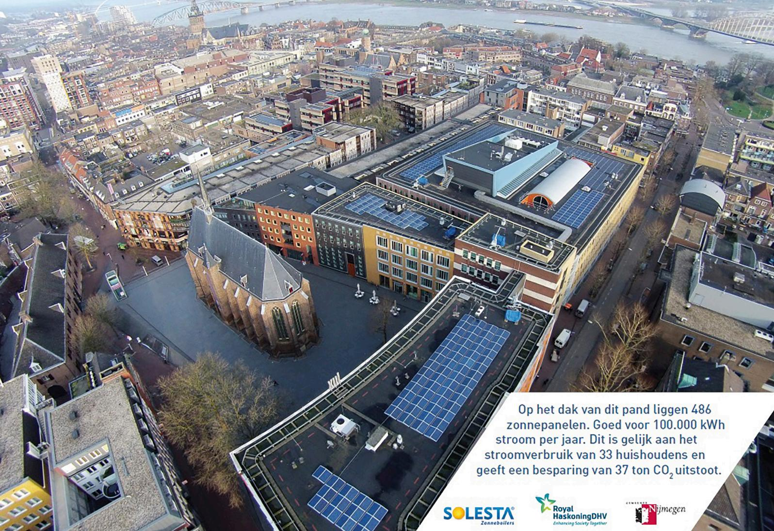
Op het dak van dit pand liggen 486 zonnepanelen. Goed voor 100.000 kWh stroom per jaar. Dit is gelijk aan het stroomverbruik van 33 huishoudens en geeft een besparing van 37 ton CO<sub>2</sub> uitstoot.
