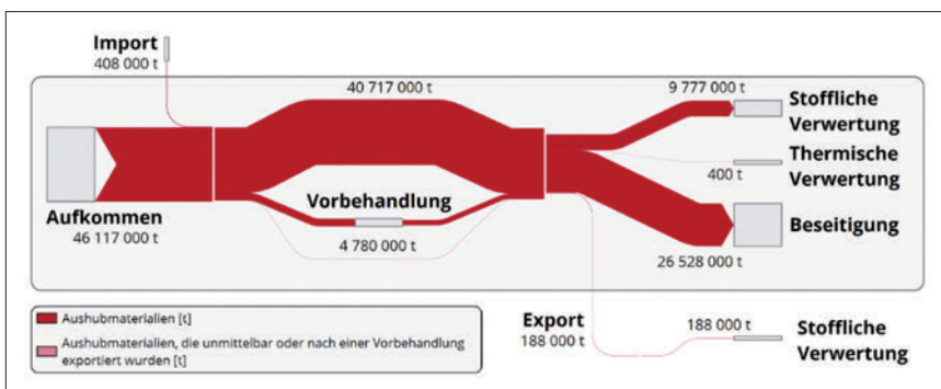
Abb. 2: Stoffstrombild für Aushubmaterialien (Referenzjahr 2021, in t); Quelle: Die Bestandsaufnahme der Abfallwirtschaft in Österreich - Statusbericht 2023 für das Referenzjahr 2021, S. 227.
